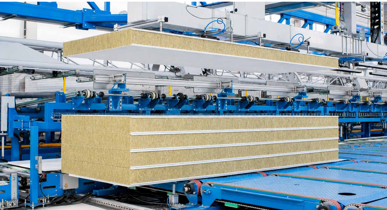
Завод стеновых и кровельных сэндвич-панелей с минеральной ватой, линия непрерывного производства сэндвич-панелей
