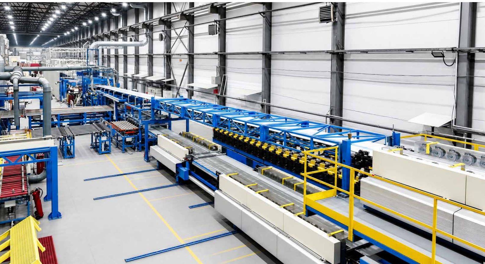
Завод стеновых и кровельных сэндвич-панелей с минеральной ватой и PIR (ПИР), автоматизированная линия
