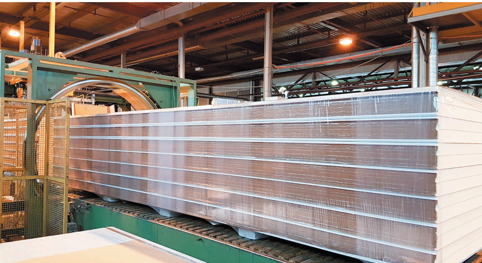
Завод стеновых и кровельных сэндвич-панелей с PIR (ПИР), автоматизированный участок упаковки PIR-панелей
